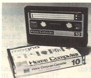
Automatisch beim Punkt Null beginnt eine neue Spezialkassette zu speichern oder Daten abzugeben. Dafür sorgt in der „Home-Computer-Cassette“ ein magnetisches Vorspannband. Der Datenträger von Magna (Köln) ist in den Laufzeiten 10, 20 und 30 Minuten konfektioniert. (Im Fachhandel).
